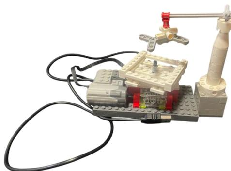
*Сборка:* на платформу устанавливаем блок зубчатых колес и червячное колесо. На ось насаживаем зубчатое колесо. На него крепим пластины с отверстиями. Присоединяем эту установку к мотору при помощи дополнительной оси. Выстраиваем вертикально из круглых кирпичиков основание и крепим к нему ось с закругленной пластиной это аналог душа. Запускаем действие мотора при помощи программы. Ура, все получилось!
