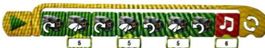
Использованные блоки «Начало», «Мотор по часовой стрелке», «Мощность мотора», «Мотор против часовой стрелки», «Мощность мотора», «Звук», «Цикл».
