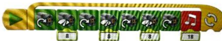
Для программирования использованы блоки «Начало», «Мотор по часовой стрелке», «Мощность мотора», «Мотор по часовой стрелке», «Мощность мотора», «Звук», «Цикл».
