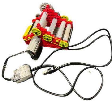
Прежде чем приступить к работе мы тщательно рассмотрели картинки настоящих чесальных машин. Изучив устройство, мы поняли, что в основе его работы также лежит механизм вращения. Так несколько валов с игольчатой поверхностью, установленных горизонтально на разной высоте, размельчают и распушают сырьё, а затем наматывают его на катушку.
