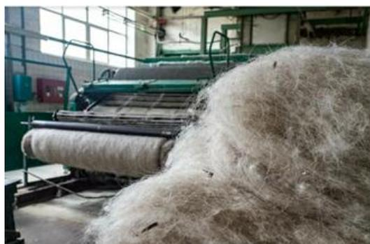
Потом по специальным трубам шерсть переходит в чесально-основальный цех. Здесь она поступает в бункер чесальной машины. Вот такая мягкая вата получается однородного цвета, очень мягкая, воздушная и легкая. Чтобы получился валенок дальше работает целая бригада. Оператор
