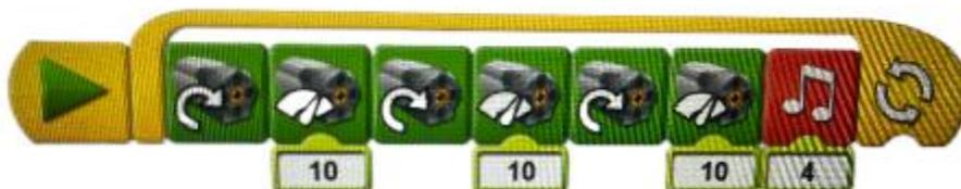
Для программирования использованы блоки «Начало», «Мотор по часовой стрелке», «Мощность мотора», «Мотор по часовой стрелке», «Мощность мотора», «Звук», «Цикл».
