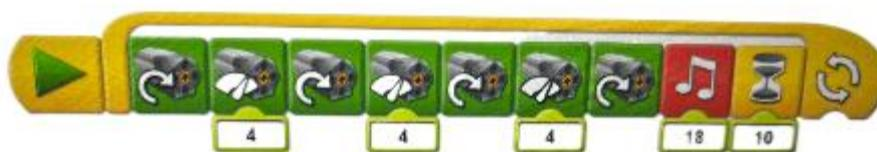
Для программирования использованы блоки «Начало», «Мотор по часовой стрелке», «Мощность мотора», «Мотор по часовой стрелке», «Мощность мотора», «Звук», «Блок ждать», «Цикл».
