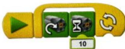
Для программирования использованы блоки «Начало», «Мотор по часовой стрелке», «Включить мотор на.....», «Цикл».
